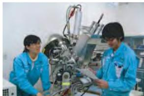
図2 X線光電子分光装置
