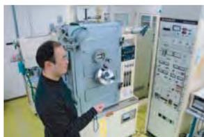
図1 イオンプレーティング装置
