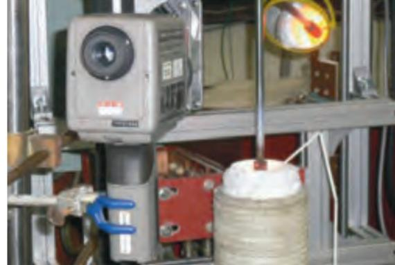
図2 誘導加熱熔融装置
