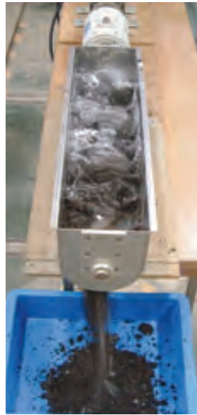
土砂と生石灰の攪拌混合実験
