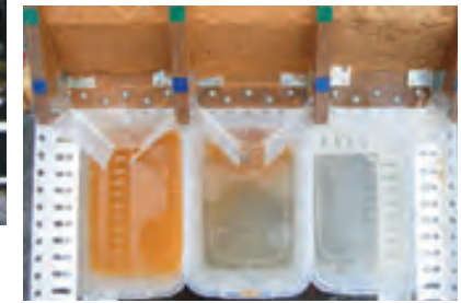
左：通常の赤土、中央：固化処理土、右：繊維質固化処理土。繊維質固化処理土はほとんど侵食されていないことが分かる。
