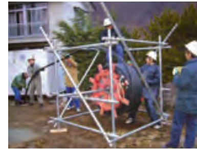
高地温勾配地域における地中熱利用システムの特性評価と設計法の確立を目指し、湯本地区においてサーマルレスポンス試験を実施した。(湯本 EIMY プロジェクト)
