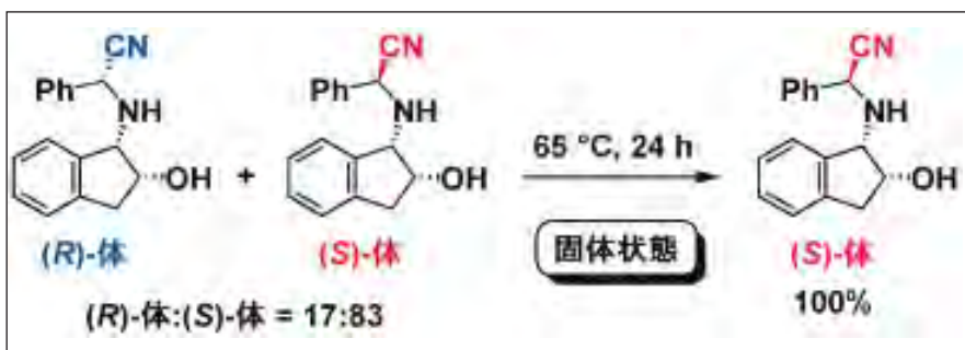
\alpha -アミノニトリルの固相異性化 (左) と (R)-体の結晶表面に (S)-体の結晶が成長する様子 (右)
