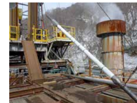
掘削時比抵抗測定装置 LWD tool for HT geothermal wells
