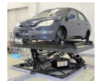
Fig.6 構築中のシミュレーター
