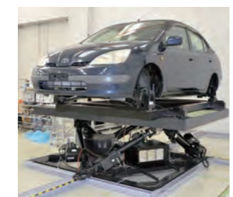
Fig.6 構築中のシミュレーター
