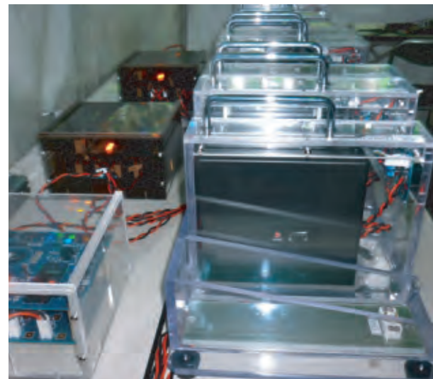
Fig.2 リチウムイオン電池の蓄電放電装置
