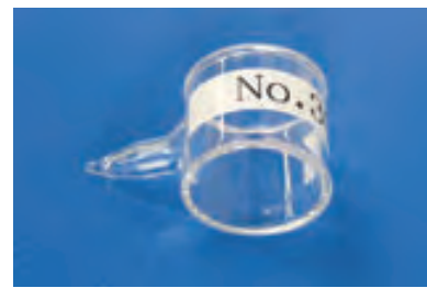
写真3. 装置関数測定に用いるHBrガスセル (直径2cm×長さ2cm)
