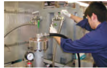
キャビテーションジェットにより分解した有機化合物試料の採取を行っている様子。（研究成果等6）に対応
