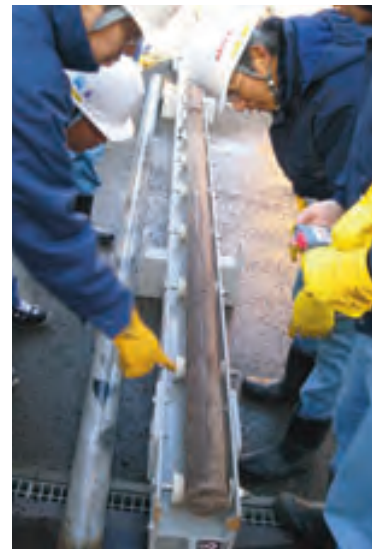
地下深部から採取された定方位コア（石油資源開発（株）勇払油ガス田にて）（研究成果等4）に対応
