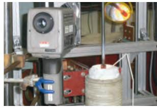
図2誘導加熱溶融装置
