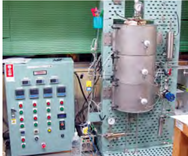
流通式水熱反応装置：有機性廃棄物の水熱反応に使用する
