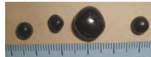
脱水ケーキを利用して生成した球形骨材：密度、吸水率など骨材としての基準をクリアし、さらに引張強度が砕石骨材と比較してほぼ同程度あるいはやや強度が高く、コンクリートの強度も十分であることを確認した。
