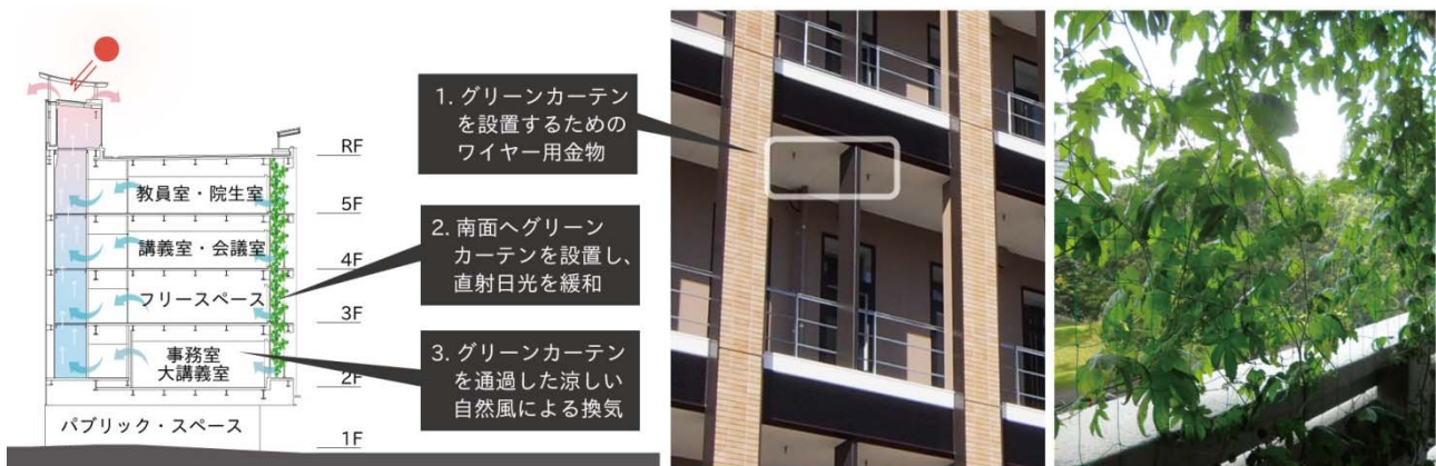
図VI-6 新棟断面:グリーンカーテンの効果 (左) グリーンカーテン用金物 (中央) 階段室のチムニーシャフト窓 (右)
