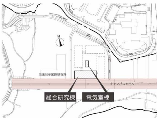
図VI-7 新棟配置図:研究室棟から独立した電気室 (左) 新棟北面:平屋独立建物/電気室 (右)
