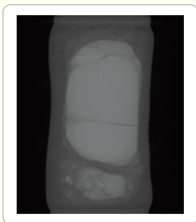
図2. 体積膨張反応により破碎されたMgO焼結体のX線CT像。試料長さ2cm。
