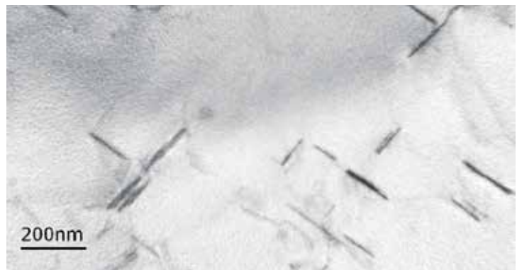
写真5 固相窒化法により針状に析出したバナジウム窒化物
