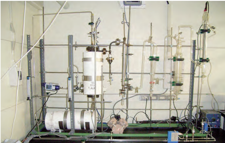
写真2 プラスチックを熱分解しリサイクルするための流動層装置
