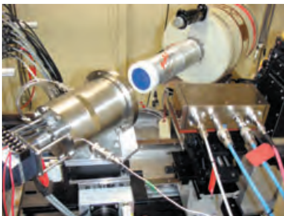
放射光施設SPring8を利用した電極反応場の高温電気化学XAFS（X線吸収分光）測定（京都大学・高輝度放射光科学研究センターとの共同研究）
