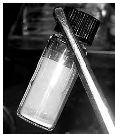
図2 Mg[NH 2 ] 2 とLiHとを複合化した新素材
