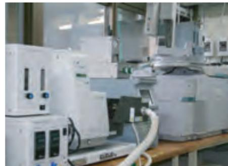
図2 熱重量—質量分析装置 (TG-MS)
