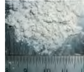
ペーパースラッジを利用して作成した土質改良材(PS材)
