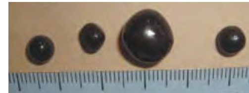
脱水ケーキを利用して生成した球形骨材：密度、吸水率など骨材としての基準をクリアし、さらに引張強度が砕石骨材と比較してほぼ同程度あるいはやや強度が高く、コンクリートの強度も十分であることを確認した。
